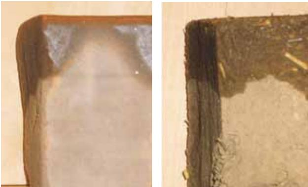
**Abb. 310** Quellversuch mit Lehmsteinen. Links stranggepresster Lehmstein  $1800 \text{ kg/m}^3$  ohne Fasern, rechts Leichtlehmstein  $1200 \text{ kg/m}^3$  mit Fasern, nach Lagerung der Steine auf feuchtgehaltenem Schwammtuch. Nach 24 Stunden ist der stranggepresste Stein stark gequollen, der faserverstärkte bleibt formstabil.
