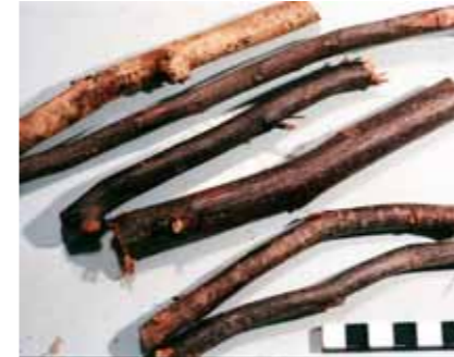
Abb. 10: Gut erhaltene Flechtruten eines Strohlehmgefaches, Außenwand von 1289, Gotisches Haus in Limburg.
