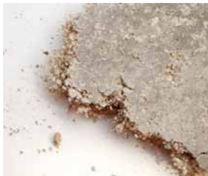
Abb. 8: Haarkalkinnenputz mit sehr guter Haftung auf dem Untergrund der Abbildung 7
