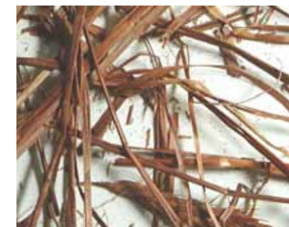
Abb. 11: Gut erhaltenes Stroh eines Strohlehm-Erstauftrags, Außenwand von 1289, Gotisches Haus in Limburg.
