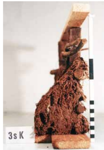
Abb. 4: Gotisches Haus, Innenwand von 1583, Erstauftrag. Der Strohlehm mit einer Trockendichte von 1100 kg/m 3 ist in großen Portionen schräg aufeinandergelegt und zwischen den Flechtruten auf die andere Seite gedrückt.
